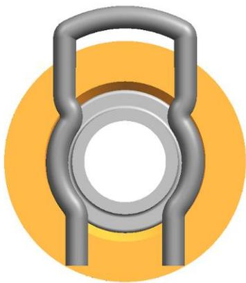
Se reduce el gap, puesto que aumenta la rigidez de la pieza y disminuye la deformación requerida para el montaje.
